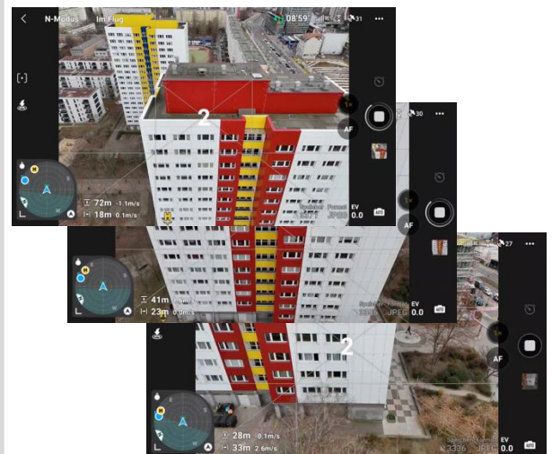
Manuelle Fassadenbefliegung per Rasterflug
